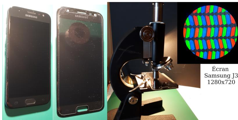
Figure 1: Les filtres rouge, verts, bleus placés devant les pixels d'un écran sont très visibles avec un microscope
